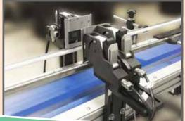
Einrichtbar für gleichzeitiges Bedrucken einer Schachtel auf zwei Seiten
